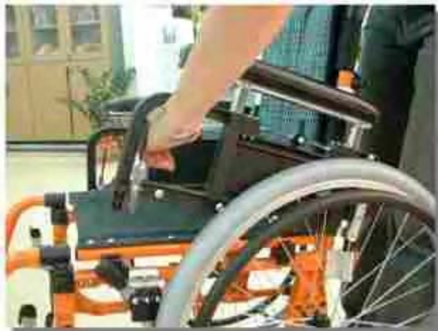
手部功能不好患者易用之特製扶手機構(可調扶手高度)
