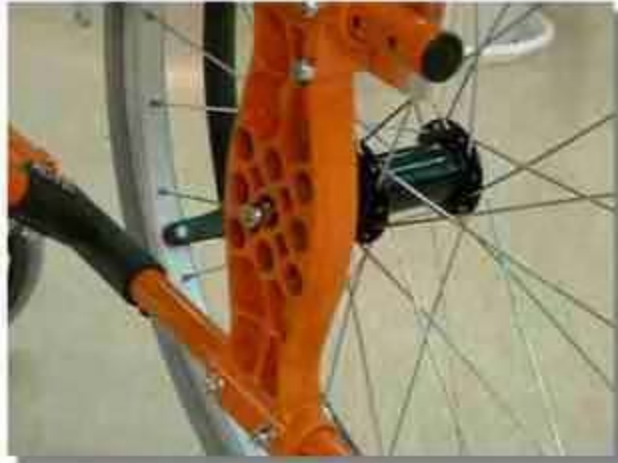
輪軸位置可調，方便不同重心配置與椅面高低調整
